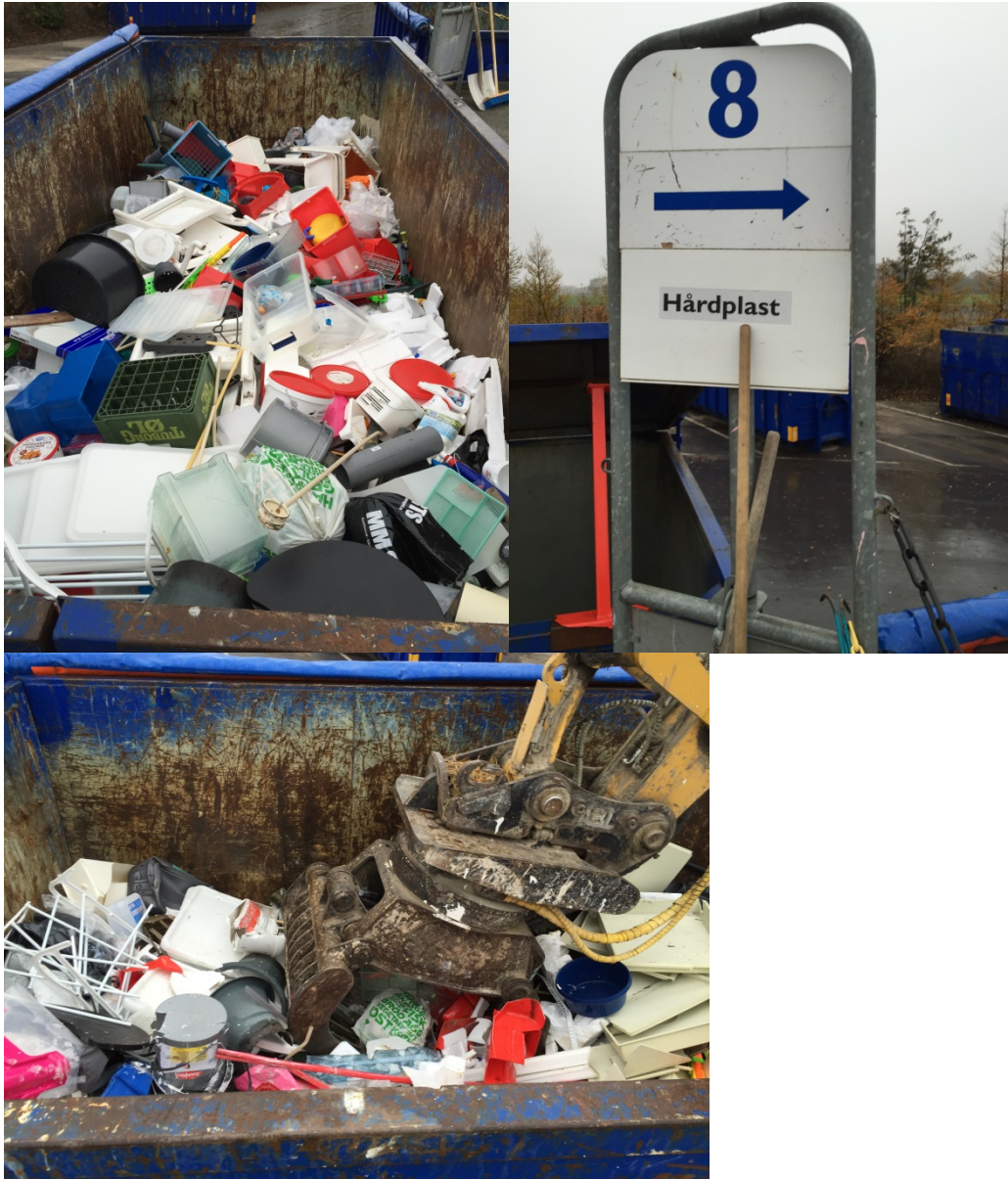
Figur 5. Insamling av hårdplast vid Bunkeflo ÅVC (överst till vänster), skylt för sorteringsinstruktion till kund (överst till höger) samt komprimering med hjälp av grävskopa (nederst). Foto: Anna Fråne.
